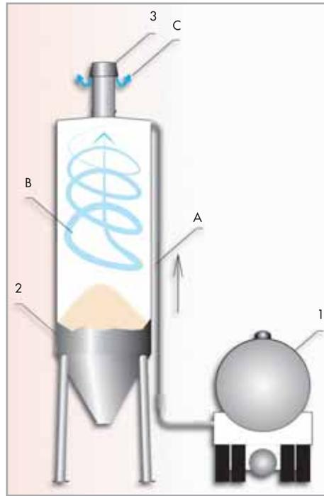
Durch eine nach unten gewandte Wirbelströmung fallen die größeren und schwereren Teilchen nach unten, während die Luft mit dem Staub nach oben steigt.
